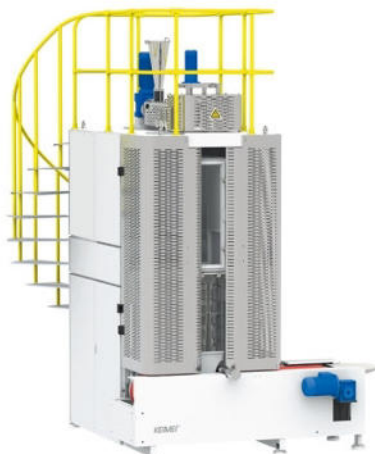
纺粘无纺布试验设备-单组份配置
