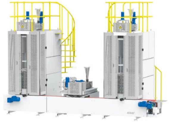
SMS无纺布实验设备-单组份配置
